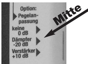
Schalter "Pegelanpassung" am HF-Analyser auf "Dämpfer -20 dB" schalten (siehe Bild). Damit tritt die integrierte Umrechnung der Anzeigeeinheit in Kraft.
