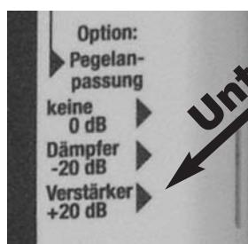
Schalter "Pegelanpassung" am HF-Analyser auf "Verstärker +20dB" schalten (siehe Bild). Damit tritt die integrierte Umrechnung der Anzeigeeinheit in Kraft.
